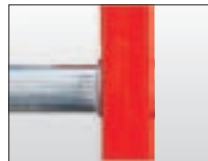
Attacco piolo-montante con doppia bordatura.
