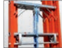
Bilanciere in alluminio a bloccaggio automatico con fune su doppia carrucola!
