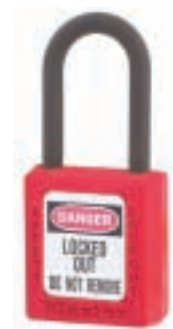
Modello LU406 - amagnetico, realizzato interamente in Zenex, archetto diametro mm. 6, lunghezza mm. 38
