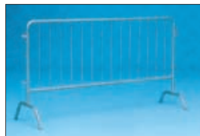
TRANSENNA PEDONALE Zincata, in tubo diametro mm 33 e tondino diametro mm 12, lunghezza m. 2, altezza cm 110. Munita di ganci collegati tra loro in linea o ad angolo. art. TS200 Transenna pedonale
